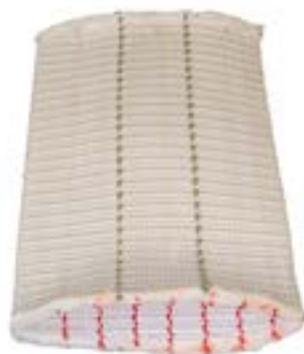
La guaina HDDT ha eccellenti proprietà di resistenza al taglio. E' realizzata in fibra HMPE con una particolare costruzione tessile 3D che la rende robusta e compatta. Al suo interno sono inseriti degli indicatori di usura di colore rosso: quando gli indicatori sono visibili esternamente, la guaina è eccessivamente usurata e va sostituita.
