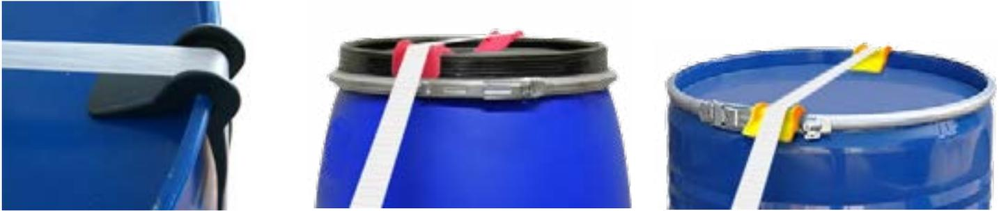
Le sicurezze per i fusti sono realizzate in robusto polipropilene, resistente ai prodotti chimici ed alle condizioni ambientali. Evitano che la reggia scivoli lungo i bordi arrotondati del fusto e quindi perda la tensione destabilizzando il carico. Possono essere utilizzati con la reggia composita o con la reggia tessuta.
