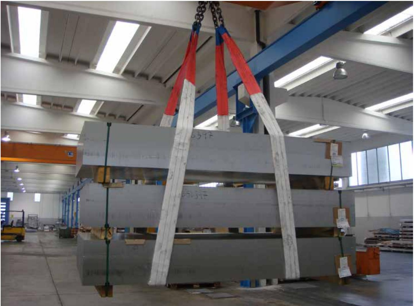
**Esempi di corretta applicazione delle protezioni sulle brache e di sollevamenti eseguiti in sicurezza**
