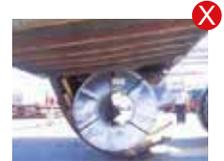
Verificare che il peso del carico sia equamente distribuito sulla base del CTU. Il baricentro del carico dovrebbe essere entro il 50% della lunghezza del contenitore. Non più del 60% del peso, oltre il 50% del piano del CTU.
