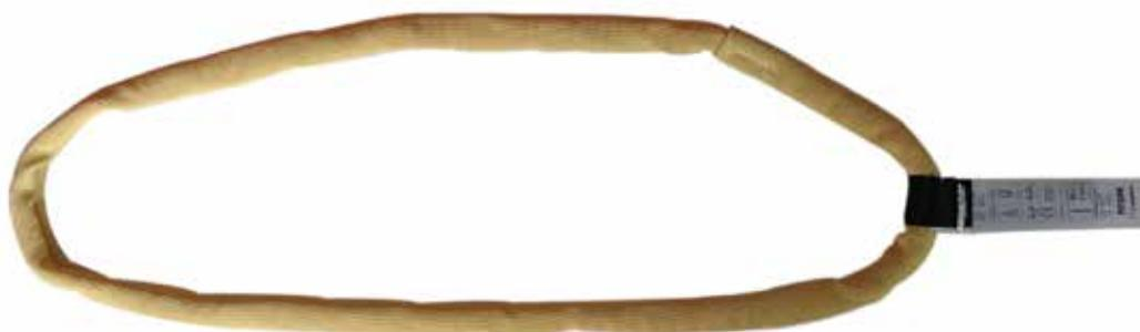
Le brache PARS sono composte da due parti, entrambe in fibra para-aramidica di colore giallo oro: il nucleo portante (core) e la copertura del nucleo (cover).
